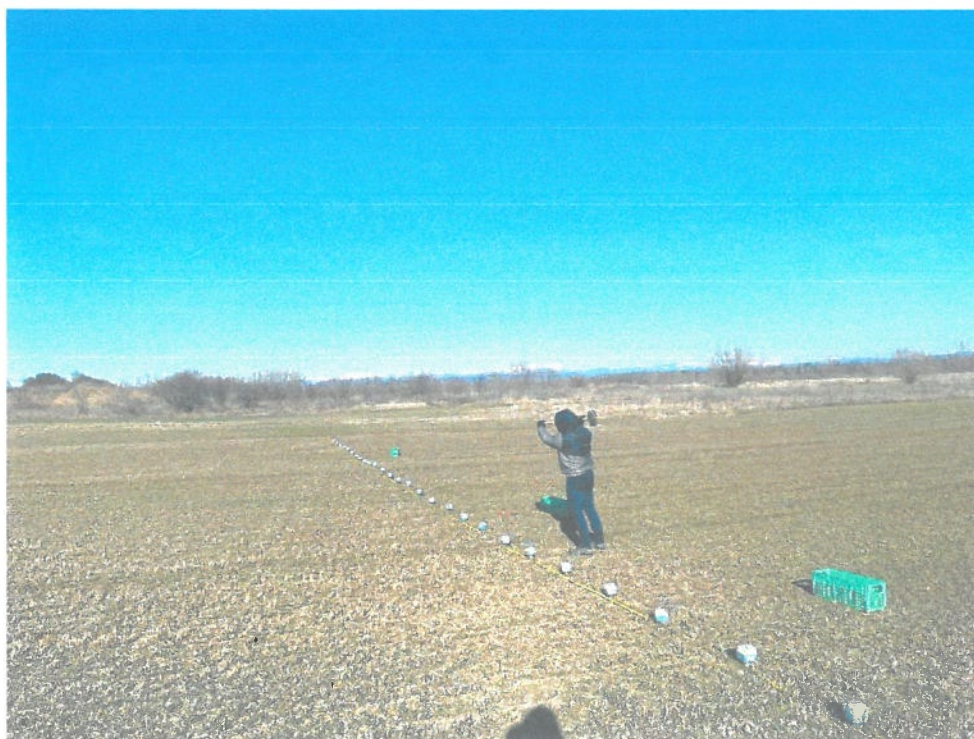
Fig. 3. Generarea undelor seismice
